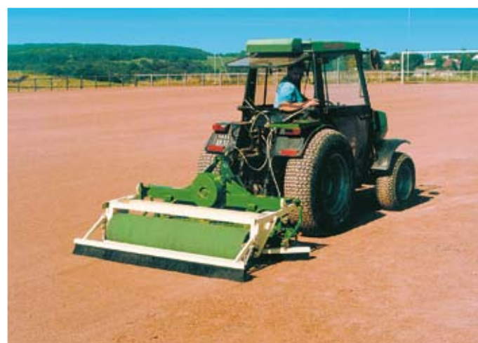
De onderhoudscombinatie voor verharde velden zorgt voor het egaliseren van de door het sporten ontstane bodemoneffenheden.
